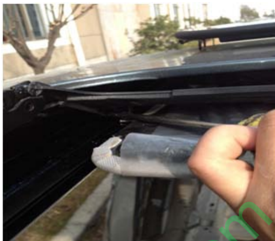
将流水槽顶出导轨
