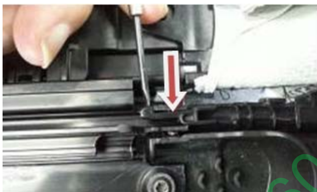
e. 将卷阳帘卡爪从导轨中挑出
