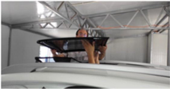
2安装移动玻璃。一人车外另一车内托举配合安装
