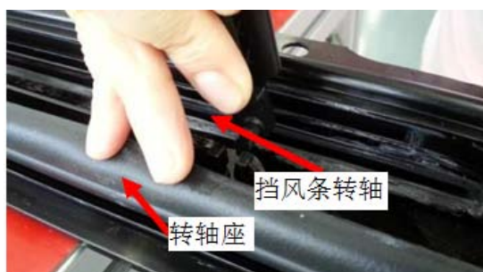
图2. 将挡风条转轴从轴承座上拆除
