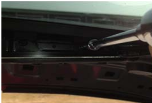
用螺丝刀松开六颗天窗玻璃固定螺钉
