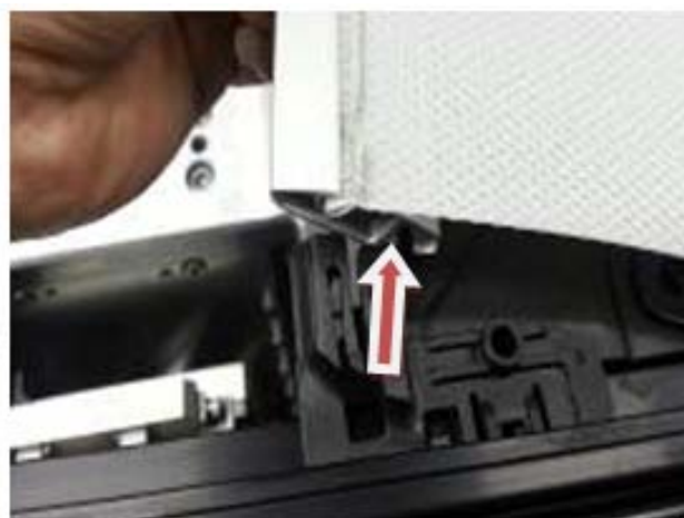
b. 将拉杆从右侧卷阳帘滑块上脱出
