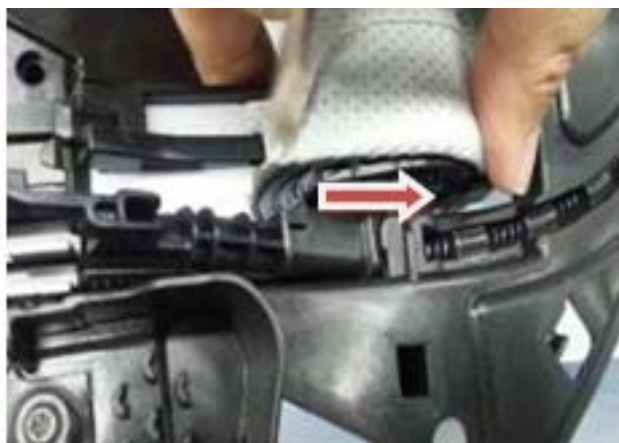
b. 将卷阳帘卷轴末端卡入后框架内
