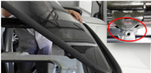
1、安装天窗固定玻璃。注意玻璃挂耳在导轨内侧
