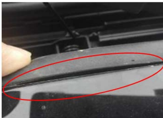
车顶密封条未安装到位，脱胶
