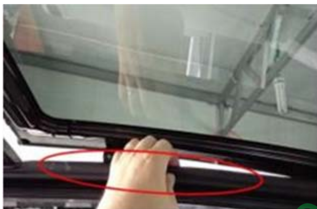
车辆点火后将天窗前玻璃起翘
