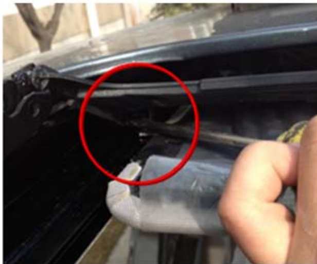
将流水槽顶出导轨
