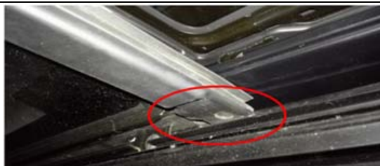
去除隔音密封条，在后玻璃前端图润滑脂
