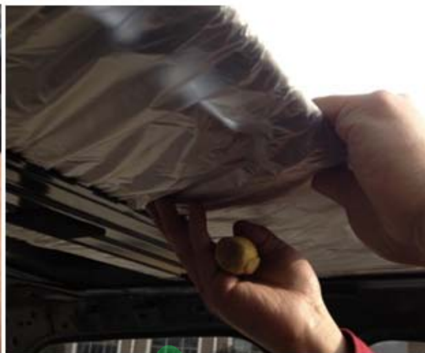
如图位置顶出遮阳板
