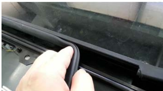
密封条挤压入后玻璃凹槽
