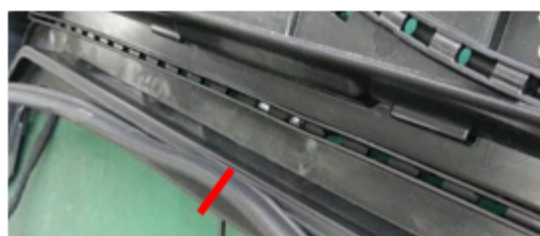
找到前框架上标识，开始隔音密封条按装
