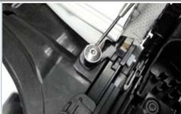
c. 用螺丝刀松开卷阳帘固定螺钉
